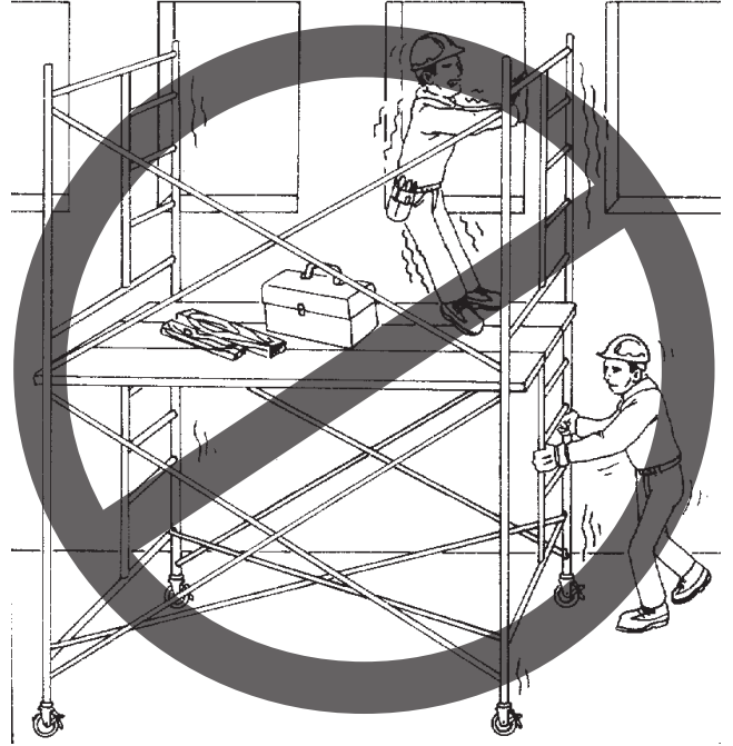
Déplacement d'un échafaudage mobile alors qu'un travailleur s'y trouve
