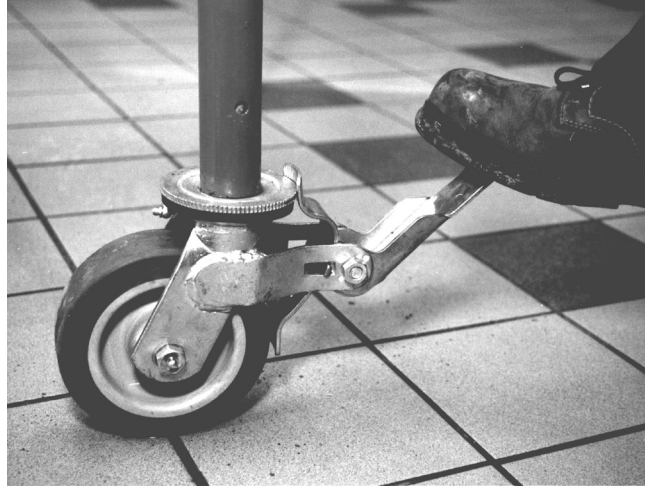
Roulette porteuse pivotante munie d'un frein
