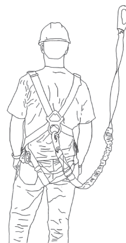
Harnais de sécurité muni d'un absorbeur d'énergie
