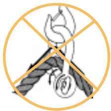
Figure 3.20 Déplacement de l'élingue sur le manillon
