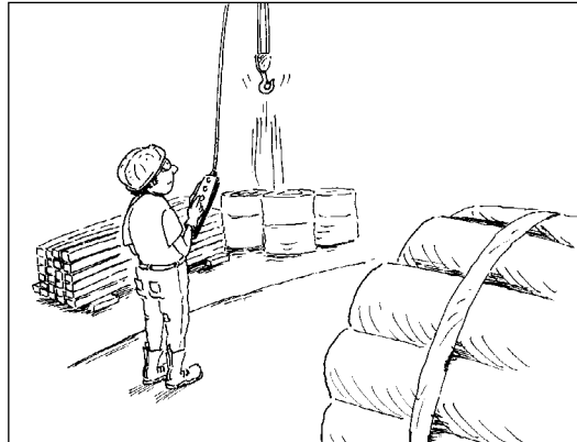
Le crochet du pont roulant est remonté à une hauteur suffisante.
