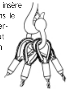
Figure 3.23 Insertion de plusieurs boucles d'élingues
